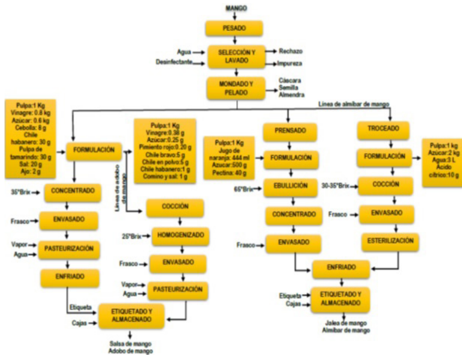
Figura 3. Diagrama de proceso para la preparación de productos artesanales a partir de mangos de traspatio. De izquierda a derecha: salsa, adobo, jalea y almibar de mango.
